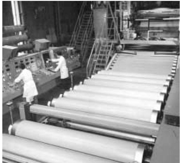
Fabrication d'une feuille extrudé
